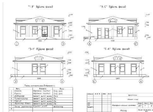
Rasm-9. Amaldagi davlatlararo GOST 21.501-2018 standarti asosida chizilgan fasad namunasi.
